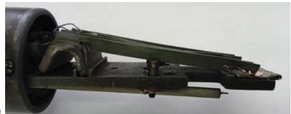
б) Рисунок 2 б – термопара находится внизу зонда.
