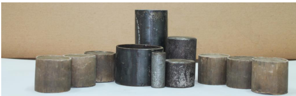
Рисунок 1 - Полая цилиндрическая прессформа
