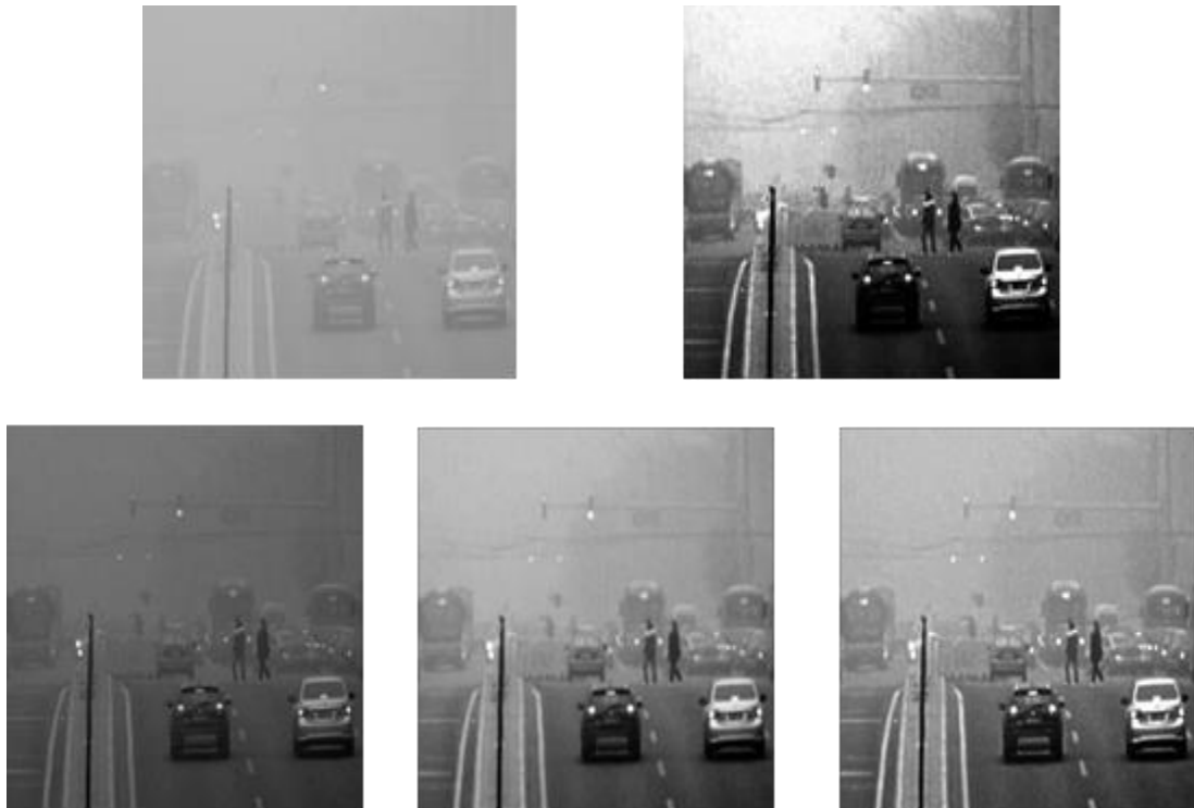
Рисунок 2 – Изображение транспортного потока в дымке улиц (а) Исходное изображение, (б) Вейвлет-преобразование, (в) Гомоморфная фильтрация (г) Квантовая вероятностная статистика (д) Квантовый метод
