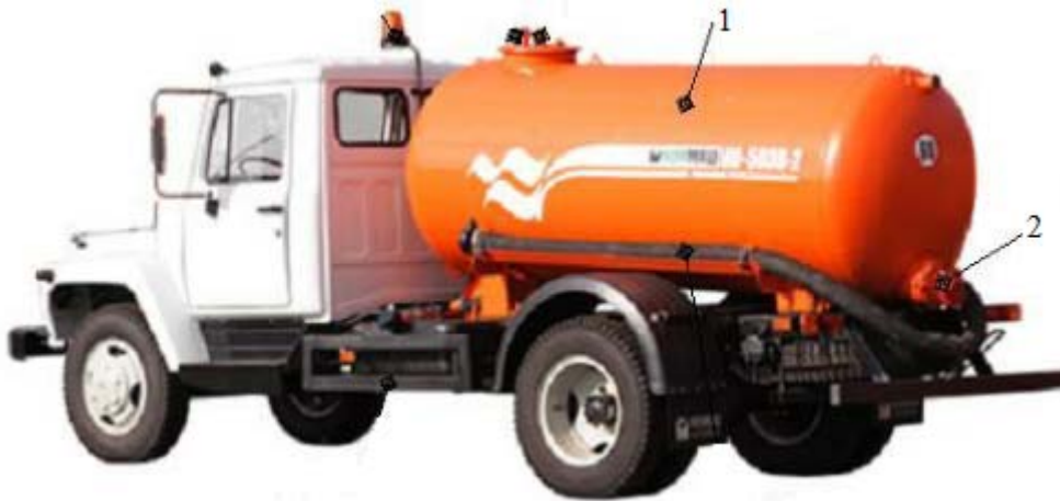
Рисунок 3 – Общий вид канализационной установки КО-503В на базе автомашины ГАЗ-3307 [2]: 1 – цистерна, 2 – люк для присоединения рукава
