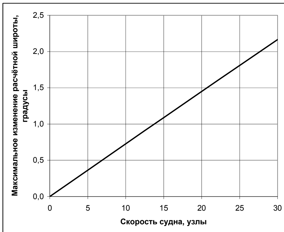
Рисунок 10 – Зависимость максимального изменения расчётной широты от скорости судна
