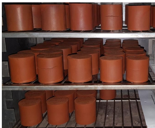
Рисунок 5 – Обожжённые образцы на основе ТПУ
