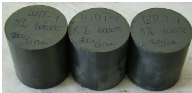
Рисунок 4 – Отпрессованные образцы на основе ТПУ
