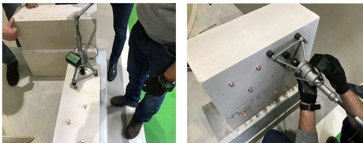
Рисунок 4 – Проведение испытаний на выдергивание анкера из блока при расположении прибора в вертикальном и горизонтальном положениях
