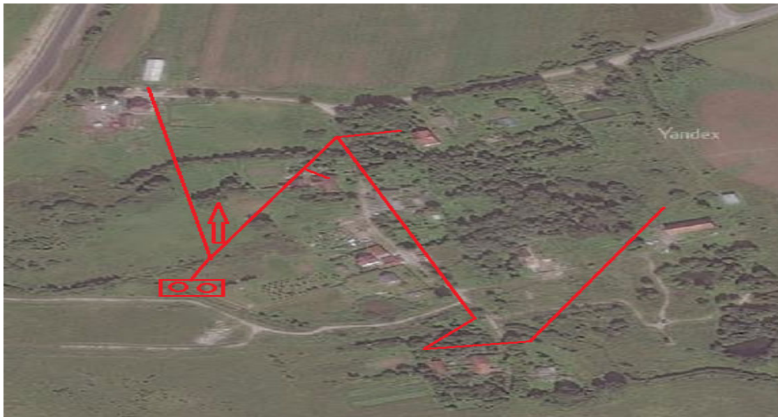
Рисунок 1 – Трассировка водопроводной сети на Yandex-карте посёлка Горловка
