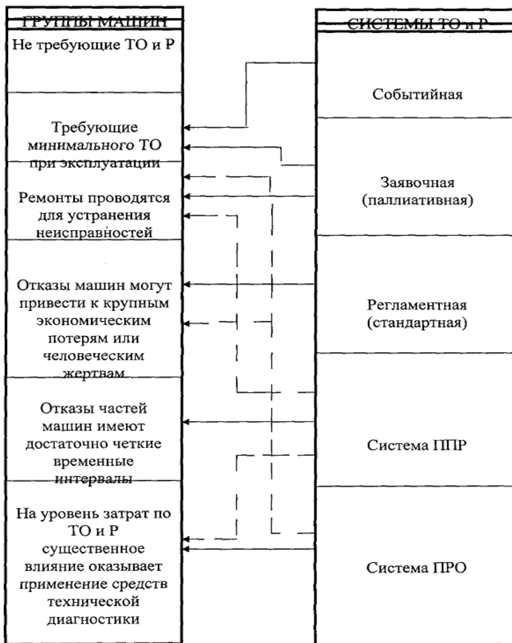
Рисунок 2 – Схема взаимосвязей групп техники с системами обеспечения работоспособности и машин: — — — предпочтительные связи; - - - допустимые связи
